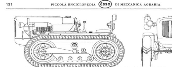
Fig. 302 Cingolo tubolare Bonmartini montato su trattore agricola.
